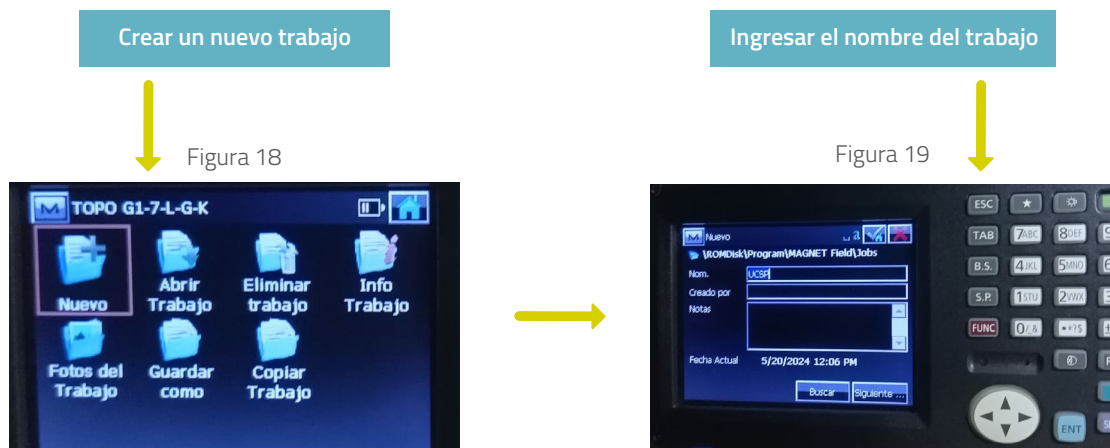
FIGURAS 18-19. Software Magnet Field. Carpeta Nuevo para la configuración de la estación total Topcon OS-105.
