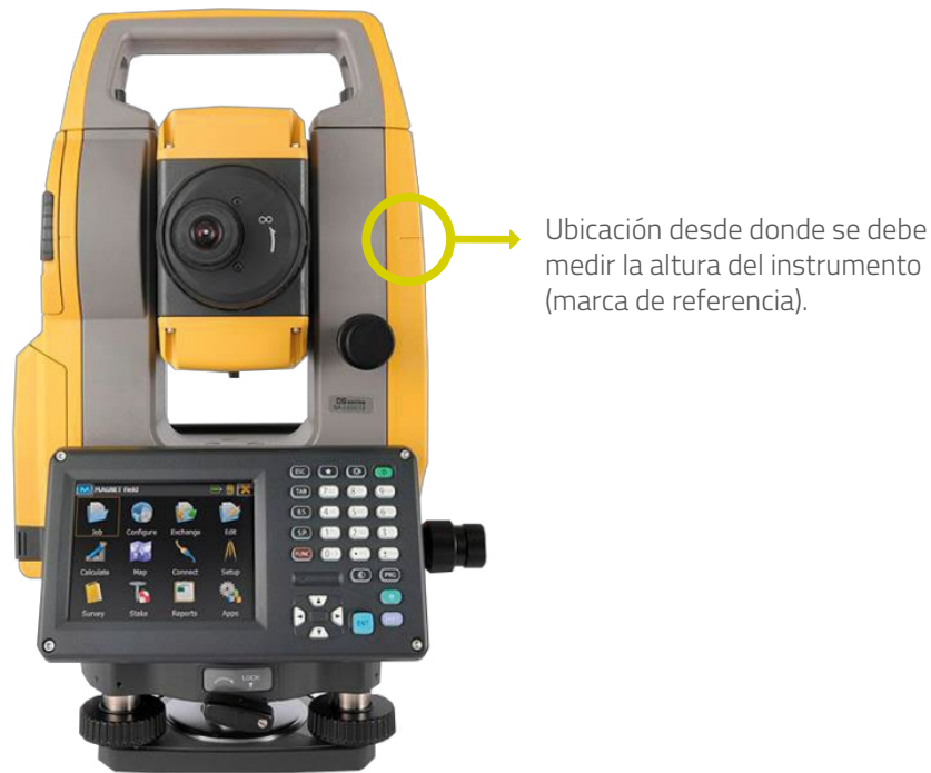
FIGURA 44. Ubicación medición altura equipo.
