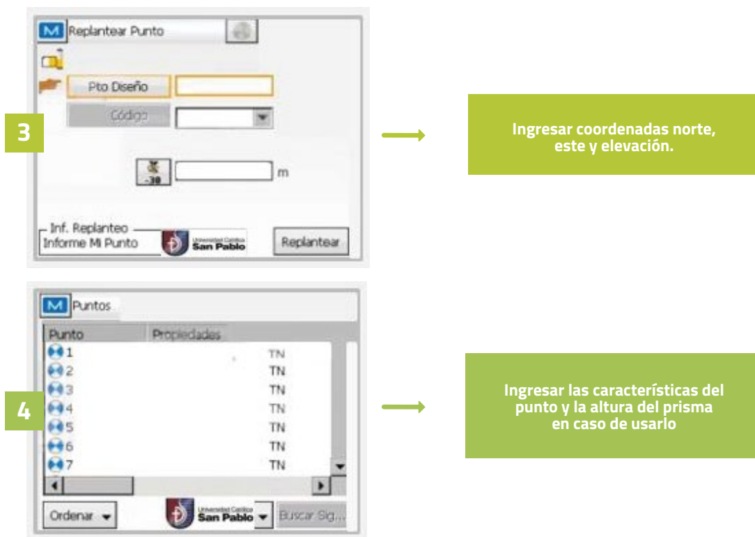
FIGURA 59. Software Magnet Field. Comando definir estilo de puntos.
