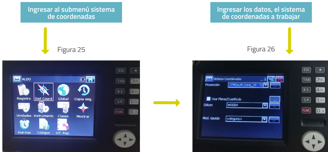
FIGURAS 25-26. Software Magnet Field. Carpeta Sist. Coord. configuración de la estación total Topcon OS-105.
