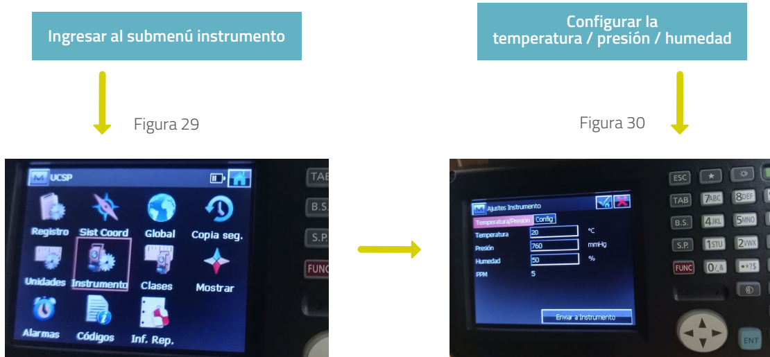
FIGURAS 29-30. Software Magnet Field. Carpeta Configuración del instrumento estación total Topcon OS-105
